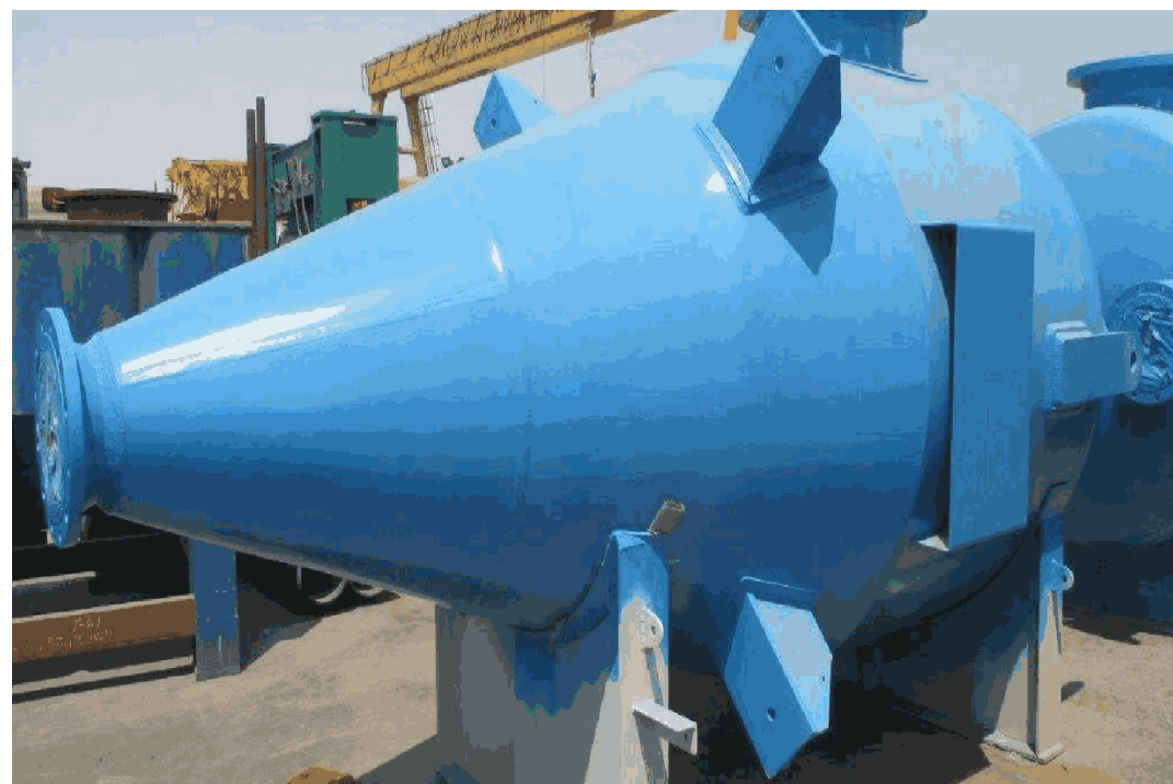
Depósitos de descarga presurizados del producto
